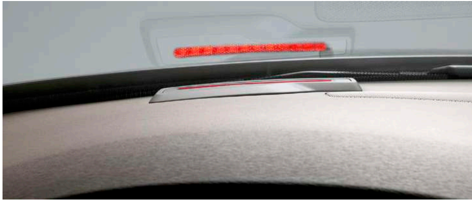
Anticipation de collision avec freinage automatique à pleine puissance CWAB et détection des piétons
