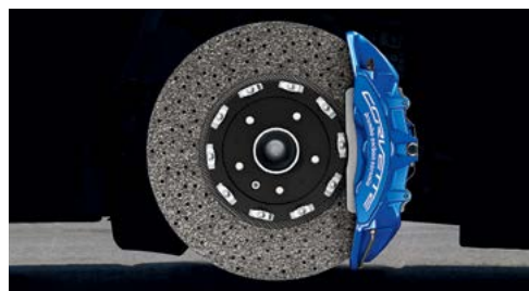
Étriers bleus de série pour ZR1 (couplés au système de freins hautes performances en carbone-céramique)
