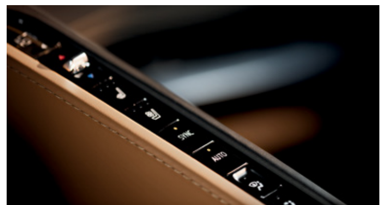
COMMANDES FAUTEUILS ET CLIMATISATION AU SOMMET DU CONTREFORT DANS L'HABITACLE
