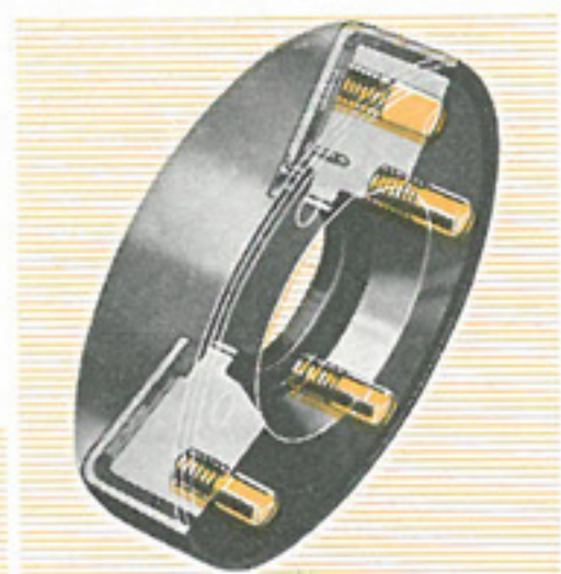
Cet amortisseur de vibration—exclusif à Packard—absorbe les tremblotements du vilebrequin, dus aux efforts de torsion.
