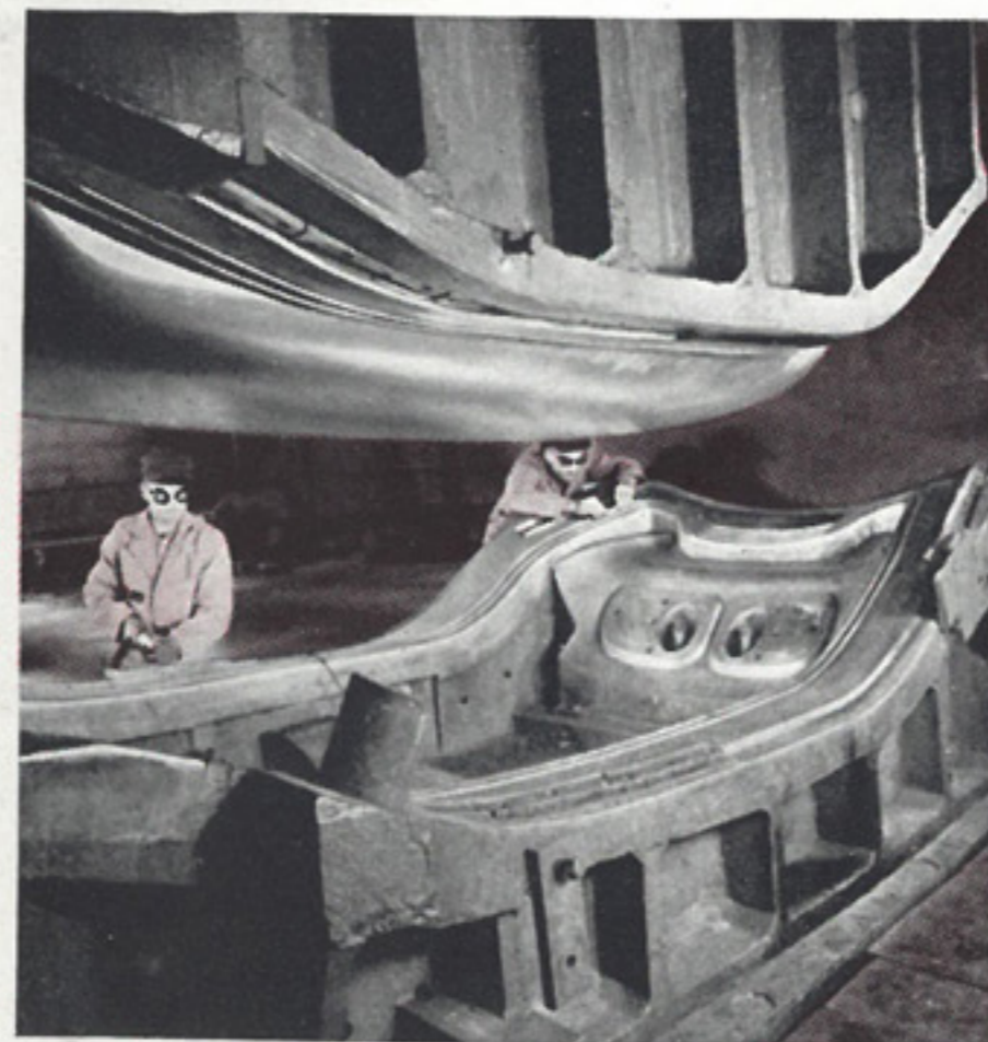
Packard a réuni sous le même toit plus de moyens de fabrication de précision, que n'importe quel autre fabricant d'automobiles de luxe. Voici sa machine à estamper.
