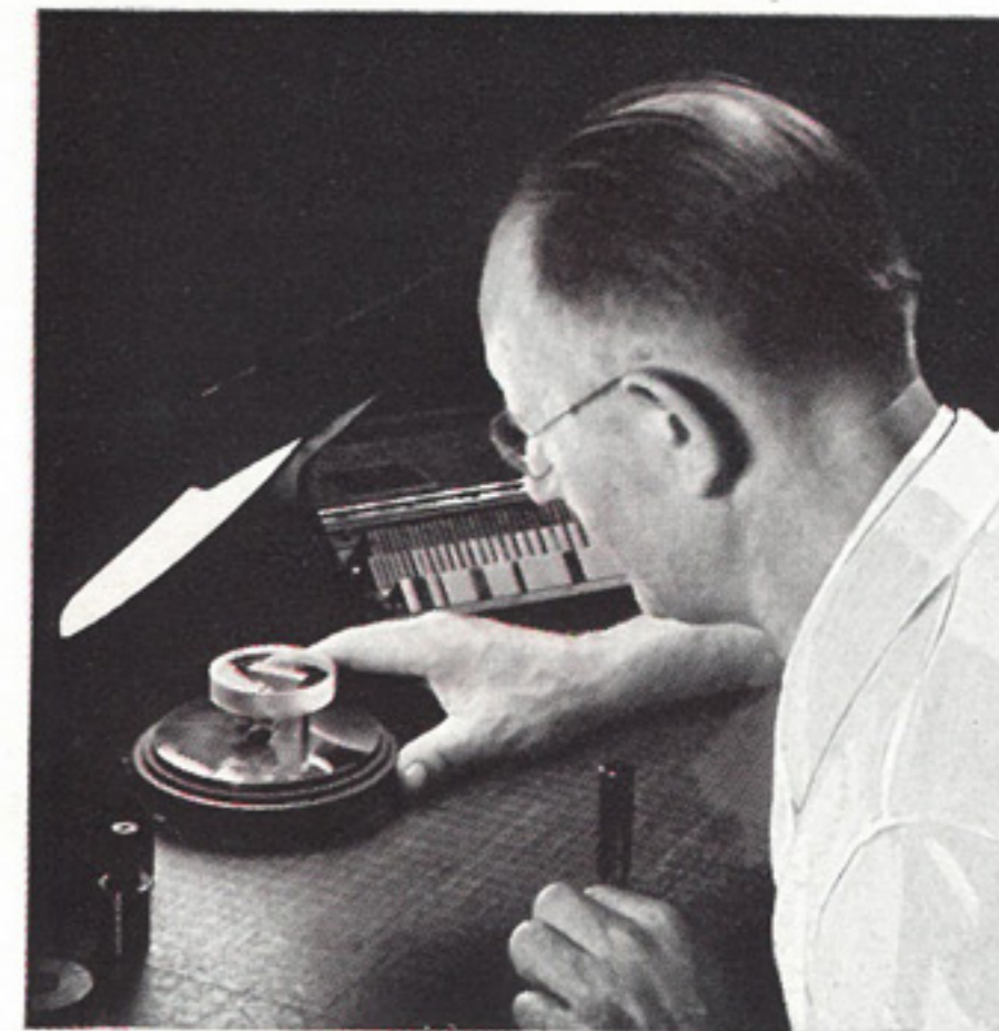
Cette machine à rayon lumineux, d'une précision absolue, est "la Cour Suprême," en matière de mesurages. Elle permet de vérifier les manomètres à un millionième de pouce près.
