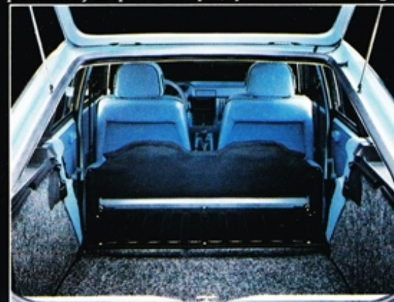
766 dm3 pour 445 kg de charge utile avec banquette AR rabattue.
