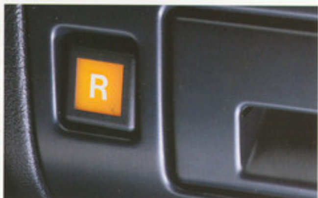
"La marche arrière s'enclenche doucement ; à l'arrêt, il suffit d'appuyer sur un bouton."
