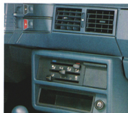
Cendrier - Allume-cigares - Emplacement pour autoradio - Bloc de commande de climatisation avec manettes de réglage air chaud/air ambiant extérieur, mini/maxi et haut/bas.
