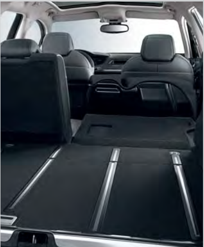
POUR UN ESPACE DE CHARGEMENT ACCRU, LA BANQUETTE ARRIÈRE PEUT ÊTRE RABATTUE EN 2/3 - 1/3. L'ARRIÈRE DU DOSSIER PROLONGE LE PLANCHER PLAT.
