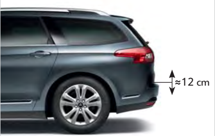
UNE COMMANDE PLACÉE SUR LE CÔTÉ DROIT DU COFFRE PEUT ÊTRE ACTIONNÉE, MOTEUR COUPÉ, POUR ABAISSER OU RELEVER LE SEUIL D'ENTRÉE DE COFFRE D'UNE AMPLITUDE DE 12 CM, SELON VERSION.
