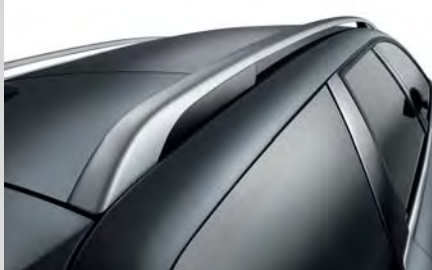
LES BARRES DE TOIT EN ALUMINIUM PEUVENT ACCUEILLIR DIFFÉRENTS ÉQUIPEMENTS CONÇUS PAR CITROËN ET DISPONIBLES EN ACCESSOIRE.
