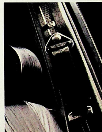
Réglage du point d'ancrage des ceintures de sécurité AV en fonction de la morphologie de l'utilisateur.
