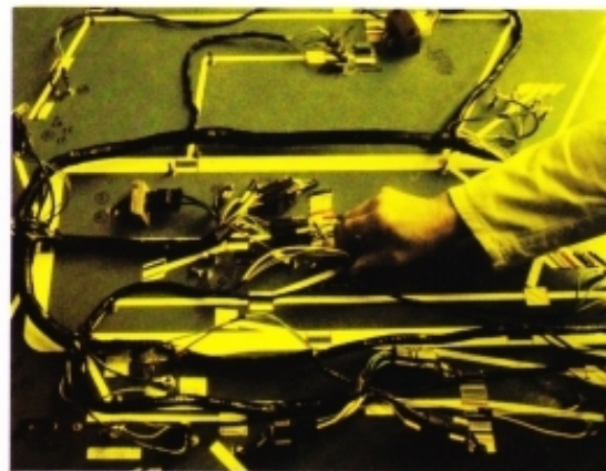
Confection d'un faisceau électrique.
