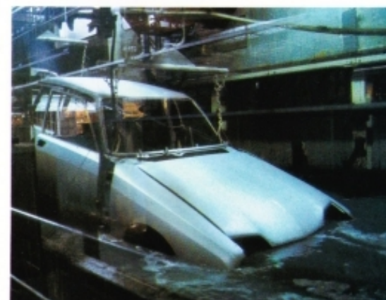
Passage d'une caisse au bain d'électrophorèse.
