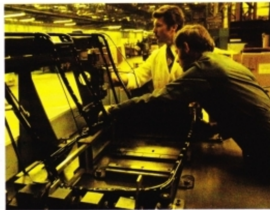
Contrôle de résistance d'une armature de siège.
