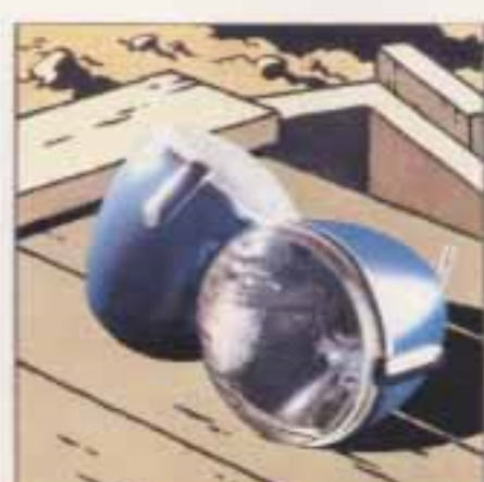
De nombreux éléments de carrosserie, et même les phares, se démontent avec une clé et un tourne-vis.
