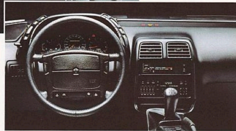
Une instrumentation analogique complète vous informe de toutes les fonctions vitales, notamment la tension, la pression d'huile, la température du moteur et la suralimentation.
