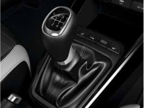
Boîte manuelle. Le Kia Stonic se dote d'une boîte manuelle à 6 rapports : disponible sur la motorisation 1.0 essence T-GDi 100 ch ISG BVM6 ou sur la motorisation 1.0 T-GDi 120 ch à hybridation légère (MHEV).
