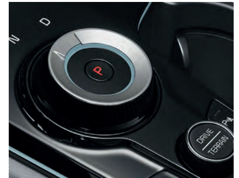
La transmission électronique passe rapidement les vitesses, tandis que le sélecteur du mode de conduite de série ajuste la réponse de la transmission, de l'accélérateur et de la direction.
