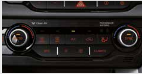
Climatisation automatique bi-zone Ce système dispose d'un mode « Driver Only » qui permet de diriger le flux d'air uniquement vers le conducteur lorsque celui-ci est seul dans le véhicule afin de réaliser des économies d'énergie. (De série).
