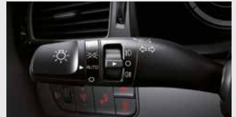
Allumage automatique des projecteurs Avec la commande en position « Auto », les projecteurs avant s'allument automatiquement en fonction de la luminosité extérieure. (De série).
