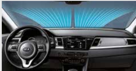
Désembuage automatique du pare-brise Des capteurs détectent toute formation de condensation à l'intérieur du pare-brise et actionnent automatiquement le désembuage pour une visibilité et une sécurité maximale. (De série).
