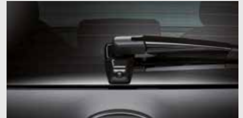
Caméra de recul intégrée astucieusement à l'essuie-glace arrière pour plus de discrétion mais aussi pour empêcher la lentille de se salir. (De série selon version).
