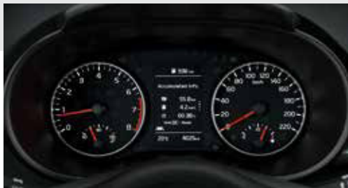
Compteur de tableau de bord central rétro-éclairé "Supervision" LCD 4,2"
