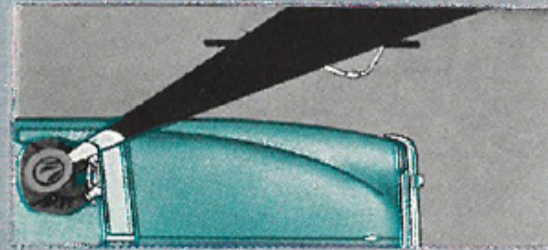
(A) L'ANCIENNE FAÇON—Montant très large—risque de danger.
