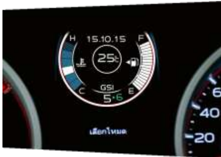
Nouvelle instrumentation du tableau de bord avec indicateur de changement de vitesse (GSI).
