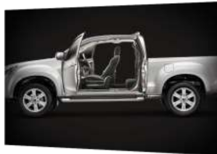
Cabine Space avec ouverture des portes antagoniste afin d'optimiser l'espace disponible.
