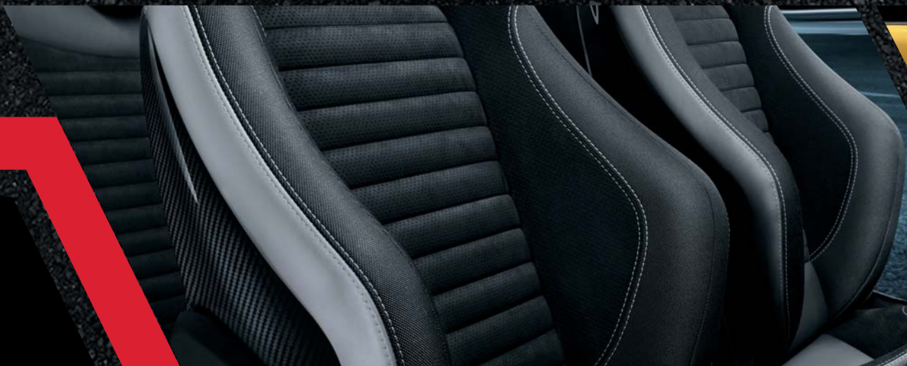
Sièges baquets Abarth Corsa par Sabelt en cuir et Alcantara® avec coque en fibre de carbone.
