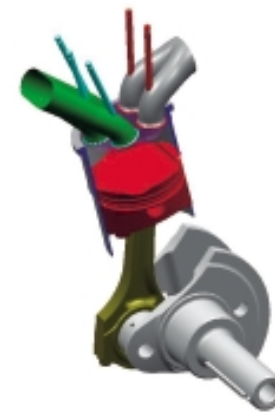
Condotti lucidati per una migliore fluidodinamica Polished inlet ports for improved fluid dynamics
