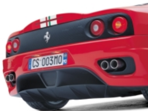
CARICO POSTERIORE Fondo posteriore a doppia superficie ottimizzato con derive longitudinali REAR LOAD Rear underbody with dual surface optimised by longitudinal turning vanes
