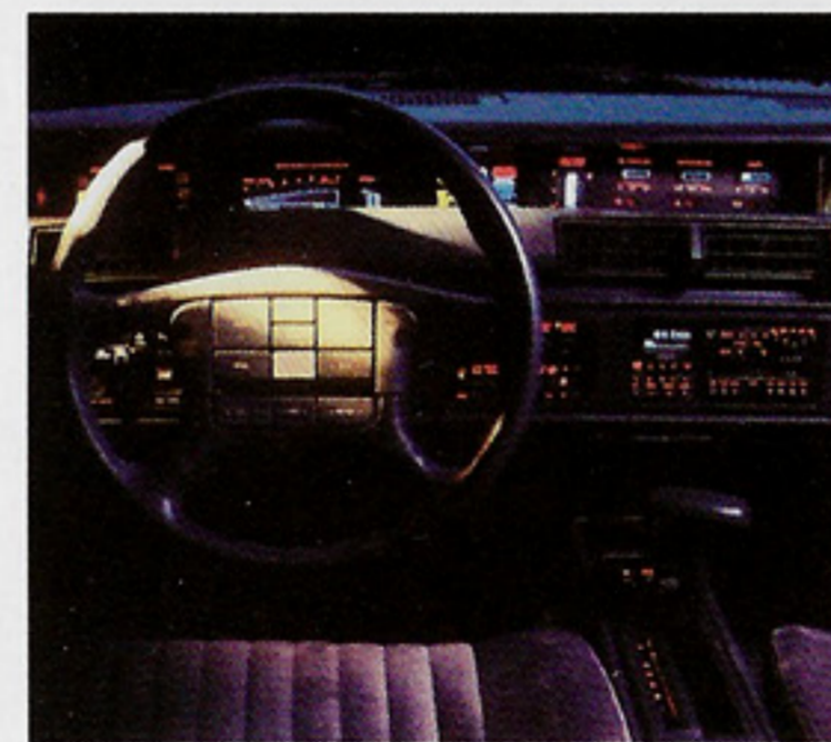
Armaturentafel im STE mit Radio-Bedienelementen in der Lenkradnabe En option sur la STE, les commandes radio intégrées au volant
