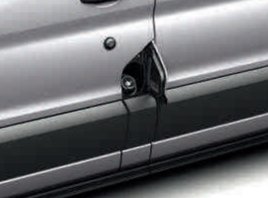
Trappe à carburant Ford Easy-Fuel (de série)
