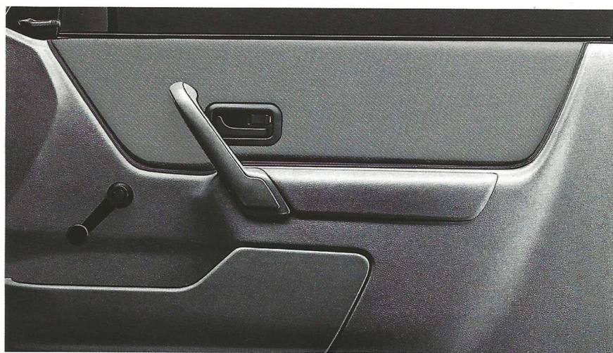
Insertion de tissu et accoudoir intégré dans les portes.
