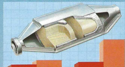
Réduction de 90% des émanations nocives grâce au catalyseur (US 83).
