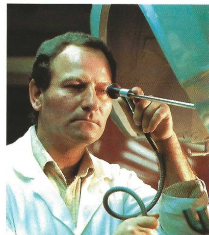
Contrôle de l'étanchéité des corps creux par endoscopie.
