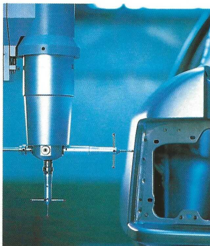
Commande par ordinateur – adaptation parfaite grâce à des mesures précises de la carrosserie.
