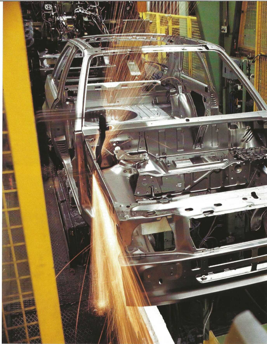
Soudage de la carrosserie par des robots commandés par ordinateur.
