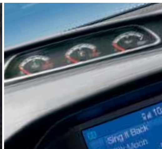
Combiné d'instruments spécifique Avec indicateurs de température d'huile, de suralimentation et de pression d'huile. (De série)
