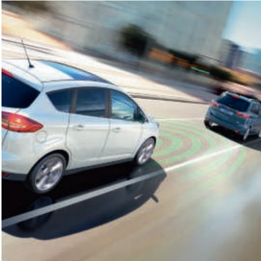
Active City Stop Ø Ce système permet de réduire le risque ou les conséquences d’un accident avec le véhicule qui précède en actionnant automatiquement les freins s’il détecte l’imminence d’une collision (de série).
