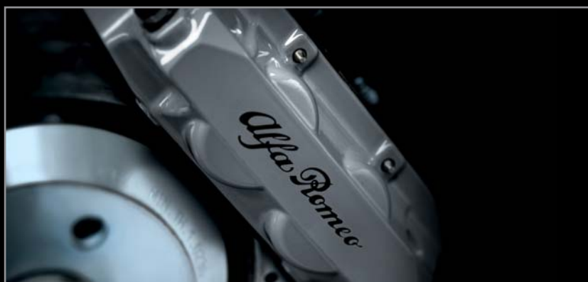
Freins avant dual-cast autoventilés percés 305 x 28 mm avec étrier fixe à 4 pistons Brembo
