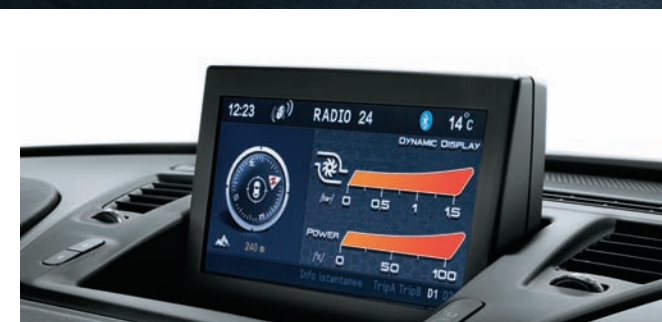
Le RadioNav affiche la pression du turbocompresseur et la puissance en %.
