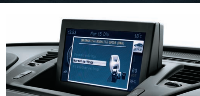
L'Alfa D.N.A. communique avec le système RadioNav : le mode de conduite sélectionné apparaît sur l'écran de votre navigateur.
