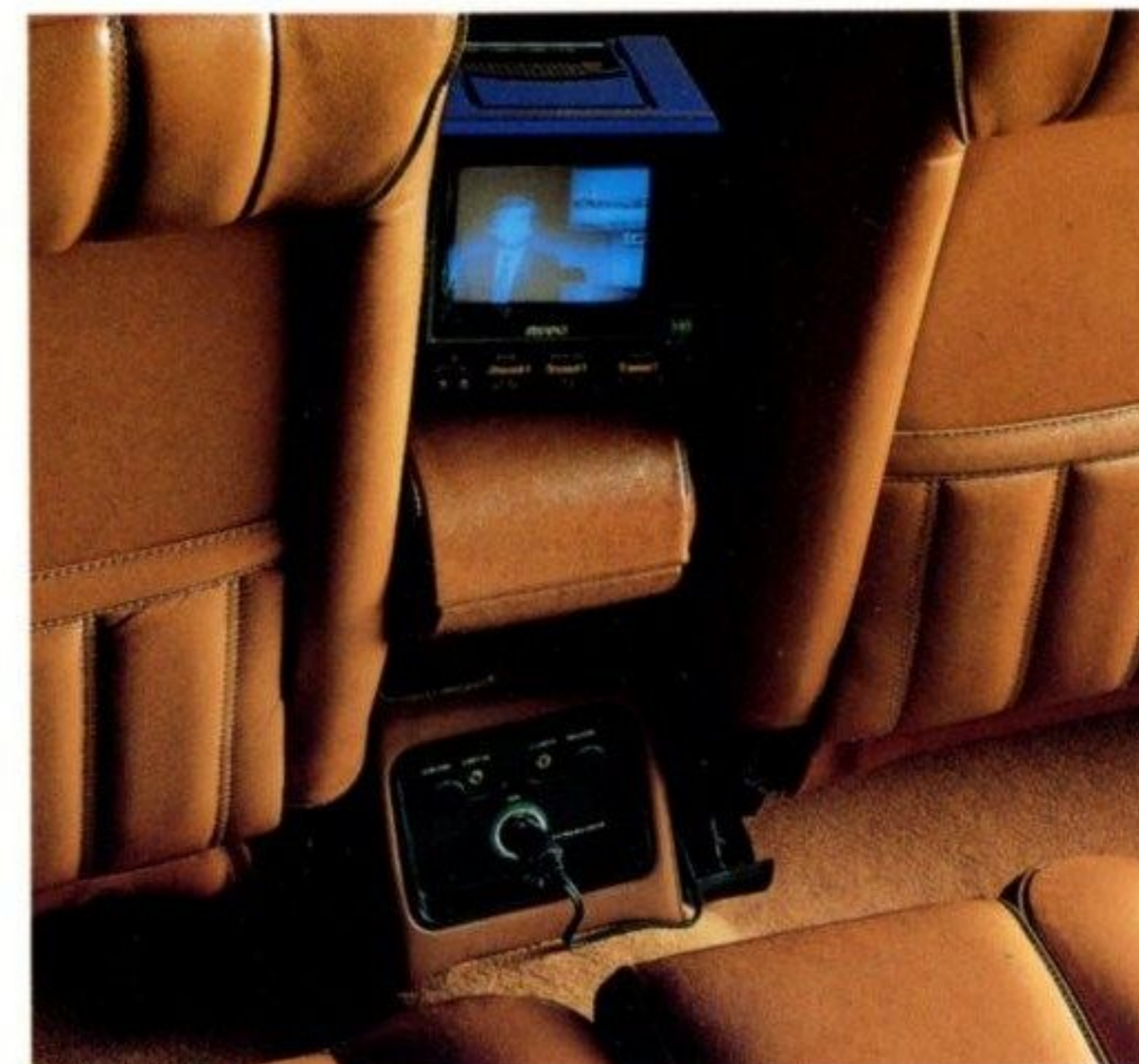
En retirant l'allume-cigare de son logement, on trouve une prise de courant sur laquelle on peut adapter une mini TV par exemple.
