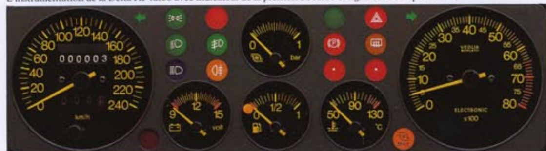
L'instrumentation de la Delta HF turbo avec indicateur de la pression du turbo et signaleur de surpression.
