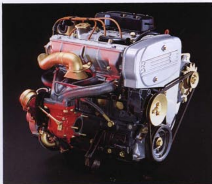
Le propulseur double arbre à injection électronique avec turbocompresseur de 1585 cm 3 développant 140 ch à 5500 tr/mn.
