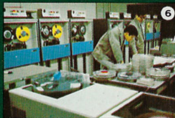
6+7 Der Produktionsvorgang jedes einzelnen Wagens wird den Computern eingegeben und auf Lochkarten festgehalten. 6+7 Le processus de production de chaque voiture prise isolément est enregistré par un «computer» puis traduit sur fiches perforées. 6+7 Il procedimento di fabbricazione d'ogni singola vettura viene immagazzinato negli elaboratori elettronici e riportato su schede perforate.
