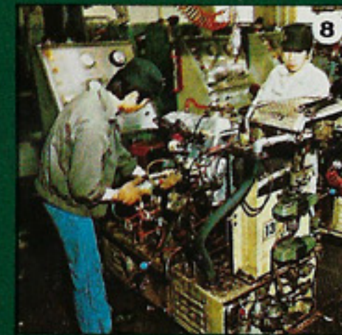
8 Auf den riesigen Motorenprüfständen wird jeder Toyota-Motor vor der Schlussmontage auf seine Leistung und eventuelle Mängel getestet. 8 Avant le montage définitif, les performances et les éventuels défauts de chaque moteur Toyota sont examinés aux énormes bancs d'essais. 8 Sui giganteschi banchi di prova dei motori, ogni motore Toyota viene sottoposto, prima del montaggio finale, a severo collaudo d'efficienza, a cui non può sfuggire il minimo eventuale difetto.
