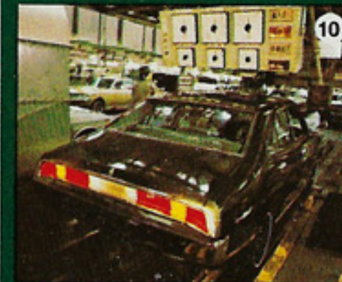
10 Bevor der Fertigwagen das Werk verlässt, wird er auf langen Teststrassen nochmals auf jedes Detail geprüft.
