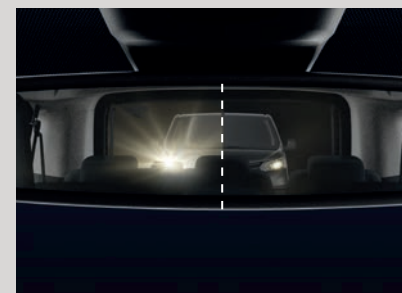
Rétroviseur intérieur anti-éblouissement (partie droite) vs normal.
