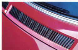
Système de ventilation Fresh-Flow avec ventilateur puissant
