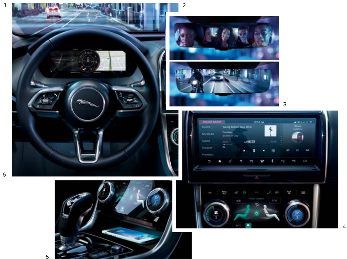
(1) Affichage tête haute (2) Pare-brise athermique (3) Rétroviseur intérieur ClearSight* (4) Touch Pro Duo (5) Chargeur smartphone à induction (6) Tableau de bord virtuel.
