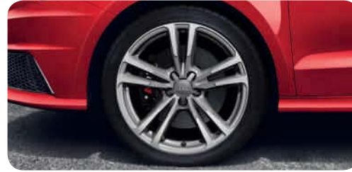
Jantes hiver en aluminium coulé style 5 branches parallèles (style S) 7,5 J x 17 avec pneus 215/40 R 17 1 , vitesse maximale autorisée 240 km/h, non compatibles chaînes-neige
