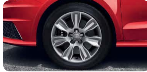
Jantes hiver en aluminium coulé style 7 branches dynamiques 6 J x 16 avec pneus 195/50 R 16 1 , vitesse maximale autorisée 210 km/h, compatibles chaînes-neige
