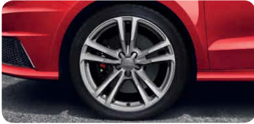
Jantes en aluminium coulé style 5 branches parallèles (style S) 7,5 J x 17 avec pneus 215/40 R 17 1
