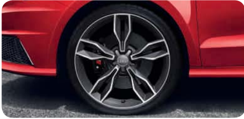
Jantes en aluminium coulé style 5 branches à facettes (style S) gris contrasté, partiellement polies 2 , 7,5 J x 18 avec pneus 225/35 R 18 1
