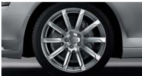
Jantes Audi exclusive en aluminium coulé style 10 rayons 8 J x 18 avec pneus 245/40 R 18
