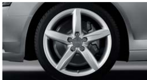
Jantes en aluminium coulé style 5 branches en étoile 8 J x 18" avec pneus 245/40 R 18
