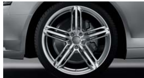
Jantes Audi exclusive en aluminium coulé style 5 branches triples 8,5 J x 19 avec pneus 255/35 R 19
