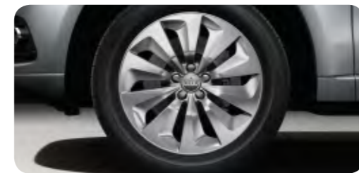
Jantes en aluminium coulé style 10 branches en turbines (style hybrid) 8 J x 19 avec pneus 235/55 R 19 1 . Uniquement pour Q5 hybrid quattro
