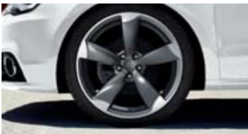
Jantes en aluminium coulé Audi exclusive style 5 branches en hélice, finition titane, polies brillant, 7,5 J x 18 avec pneus 225/35 R 18
