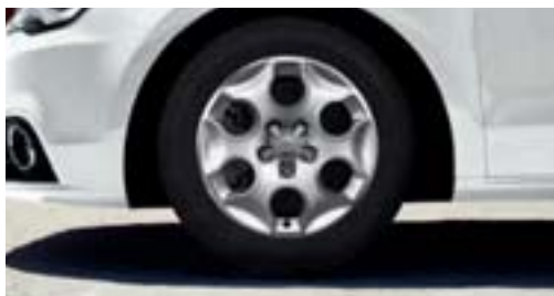
Jantes en aluminium coulé style 6 trous partiellement polies, 6,5 J x 15 avec pneus 205/55 R 15
