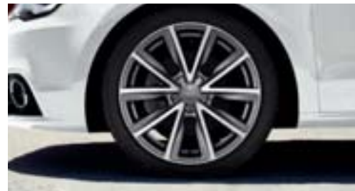
Jantes en aluminium coulé style 5 branches en V anthracite, partiellement polies, 7,5 J x 17 avec pneus 215/40 R 17
