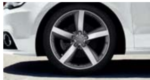
Jantes en aluminium coulé style 5 branches avec éléments décoratifs, 7,5 J x 17 avec pneus 215/40 R 17
