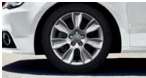
Jantes en aluminium coulé style 7 branches dynamiques 7 J x 16 avec pneus 215/45 R 16 (en option avec pneus avec propriétés de roue de secours)
