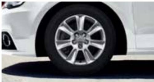
Jantes en aluminium coulé style 7 branches 6,5 J x 15 avec pneus 205/55 R 15
