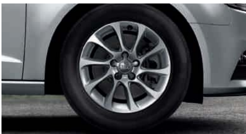
Jantes hiver en aluminium coulé style 10 branches 6,5 J x 16 avec pneus 205/55 R 16, vitesse maximale autorisée 210 km/h, non compatibles chaînes-neige
