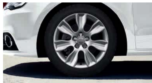
Jantes hiver en aluminium coulé style 7 branches dynamiques 6 J x 16 avec pneus 195/50 R 16 1 (en option avec pneus avec propriétés de roue de secours, compatibles chaînes-neige)
