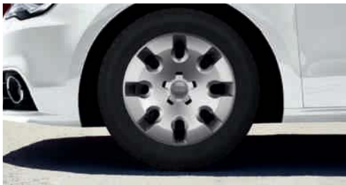
Jantes en acier avec enjoliveurs intégraux 6 J x 15 avec pneus 185/60 R 15 1 (exclusivement sur 1.2 TFSI Attraction) ; 6,5 J x 15 avec pneus 205/55 R 15 1
