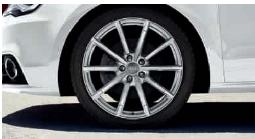
Jantes en aluminium coulé Audi Sport style 10 branches 7,5 J x 17 avec pneus 215/40 R 17 1 . Une offre de quattro GmbH
