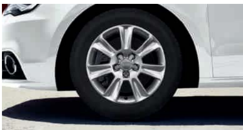
Jante en aluminium coulé style 7 branches 6,5 J x 15 avec pneus 205/55 R 15 1
