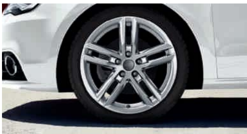
Jantes en aluminium coulé Audi Sport style 5 branches doubles 7,5 J x 17 avec pneus 215/40 R 17 1 . Une offre de quattro GmbH
