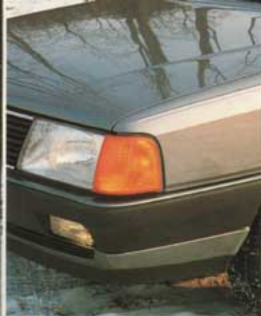
En plus de phares à iode, l'Ascott est équipée d'antibrouillards encastrés dans le pare-chocs bouclier.
