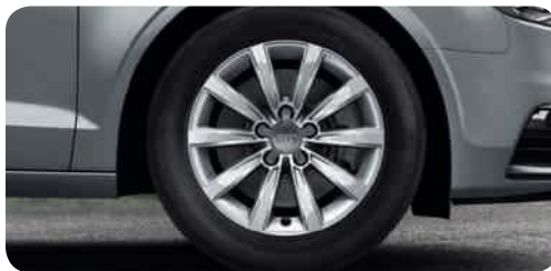
Jantes en aluminium coulé style 10 branches 7 J x 16 avec pneus 205/55 R 16 1
