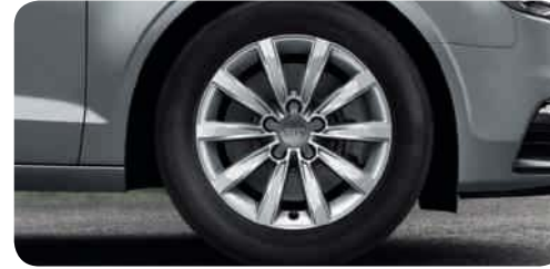
Jantes hiver en aluminium coulé style 10 branches 7 J x 16 avec pneus 205/55 R 16 1 , vitesse maximale autorisée 210 km/h, non compatibles chaînes-neige
