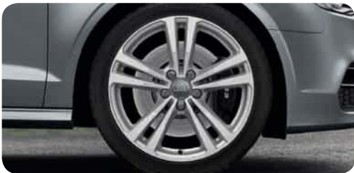
Jantes en aluminium coulé style 5 branches parallèles (style S) 3 partiellement polies 2 , 8 J x 18 avec pneus 225/40 R 18 1 . Uniquement pour S3 berline/S3 Cabriolet ou en combinaison avec le pack Sport S line
