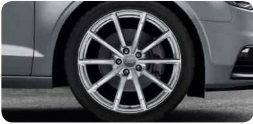
Jantes en aluminium coulé Audi Sport style 10 branches 8 J x 18 avec pneus 225/40 R 18 1 . Une offre de quattro GmbH
