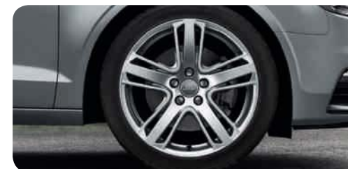
Jantes en aluminium coulé Audi Sport style 5 branches structurées 8 J x 18 avec pneus 225/40 R 18 1 . Une offre de quattro GmbH
