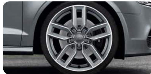
Jantes en aluminium coulé style 5 branches doubles en étoile (style S) 3 gris contrasté, partiellement polies 2 , 8 J x 19 avec pneus 235/35 R 19 1 . Uniquement pour S3 berline/S3 Cabriolet
