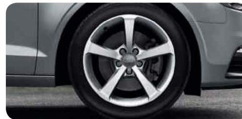
Jantes en aluminium coulé style 5 branches en étoile 7,5 J x 17 avec pneus 225/45 R 17 1
