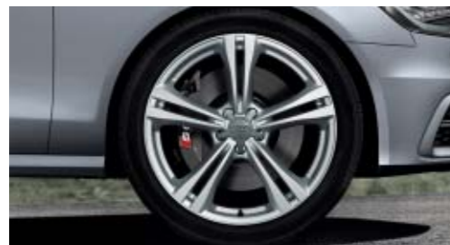
Jantes en aluminium coulé style 5 branches parallèles en étoile (style S) 8,5 J x 20 avec pneus 255/35 R 20*
