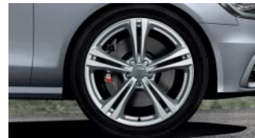
Jantes hiver en aluminium coulé style 5 branches parallèles en étoile (style S) 8,5 J x 20 avec pneus 255/35 R 20*, non compatibles chaînes-neige, vitesse de pointe possible
