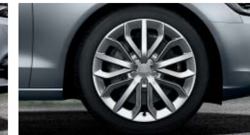
Jantes en aluminium coulé style 15 branches en étoile 8,5 J x 19 avec pneus 255/40 R 19* en option avec pneus avec propriétés de roue de secours
