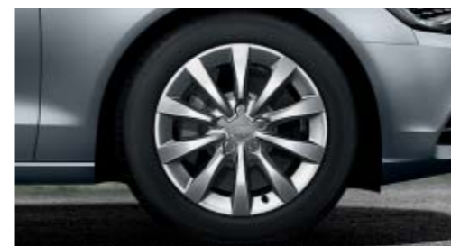
Jantes en aluminium coulé style 10 branches 8 J x 17 avec pneus 225/55 R 17* en option avec pneus toutes saisons
