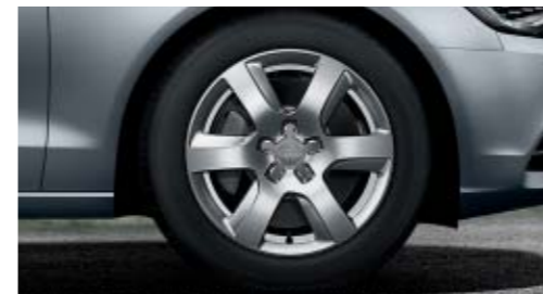
Jantes en aluminium forgé style 6 branches 8 J x 17 avec pneus 225/55 R 17*
