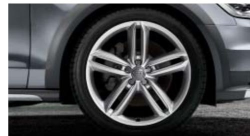
Jantes hiver en aluminium coulé style 5 branches parallèles 8,5 J x 20 avec pneus 255/40 R 20*, vitesse maximale autorisée 240 km/h
