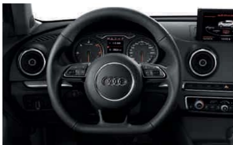
Volant Sport multifonction en cuir style 3 branches aplati en bas permet de commander les fonctions Infotainment disponibles ; réglable en hauteur et en profondeur, avec airbag grand volume ; au choix avec palettes de changement de vitesses en mode manuel sur boîte automatique
