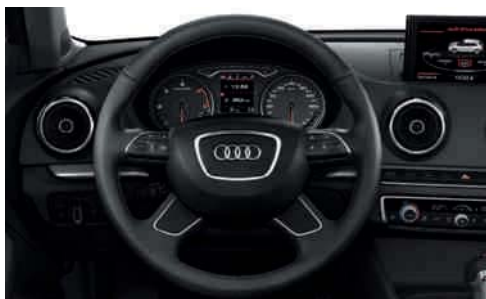
Volant multifonction en cuir style 4 branches permet de commander les fonctions Infotainment disponibles ; réglable en hauteur et en profondeur, avec airbag grand volume ; au choix avec palettes de changement de vitesses en mode manuel sur boîte automatique
