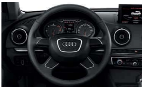
Volant en cuir style 4 branches réglable en hauteur et en profondeur, avec airbag grand volume
