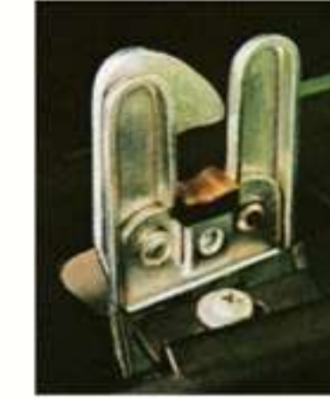
L'un des 3 verrouillages de sécurité du capot-moteur.
