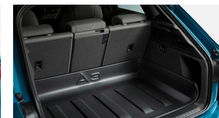
Cuve de coffre
