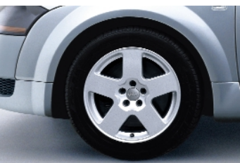
De série sur 1.8 T : Jantes en aluminium, style 5 branches, 7 J x 16, pneus 205/55 R 16 W, roue de secours à encombrement réduit.
