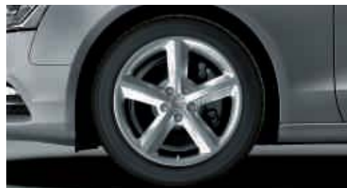
Jantes en aluminium coulé Audi exclusive style 5 branches 8,5 J x 18 avec pneus 245/40 R 18
