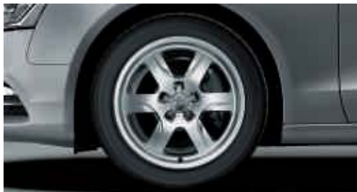
Jantes en aluminium forgé style 6 branches 7,5 J x 17 avec pneus 225/50 R 17. (De série sur Attraction)
