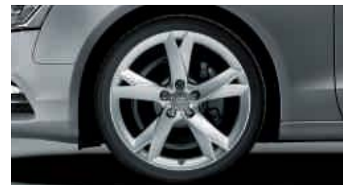
Jantes en aluminium coulé style 5 branches en Y 8,5 J x 19 avec pneus 255/35 R 19. (De série sur Avus)
