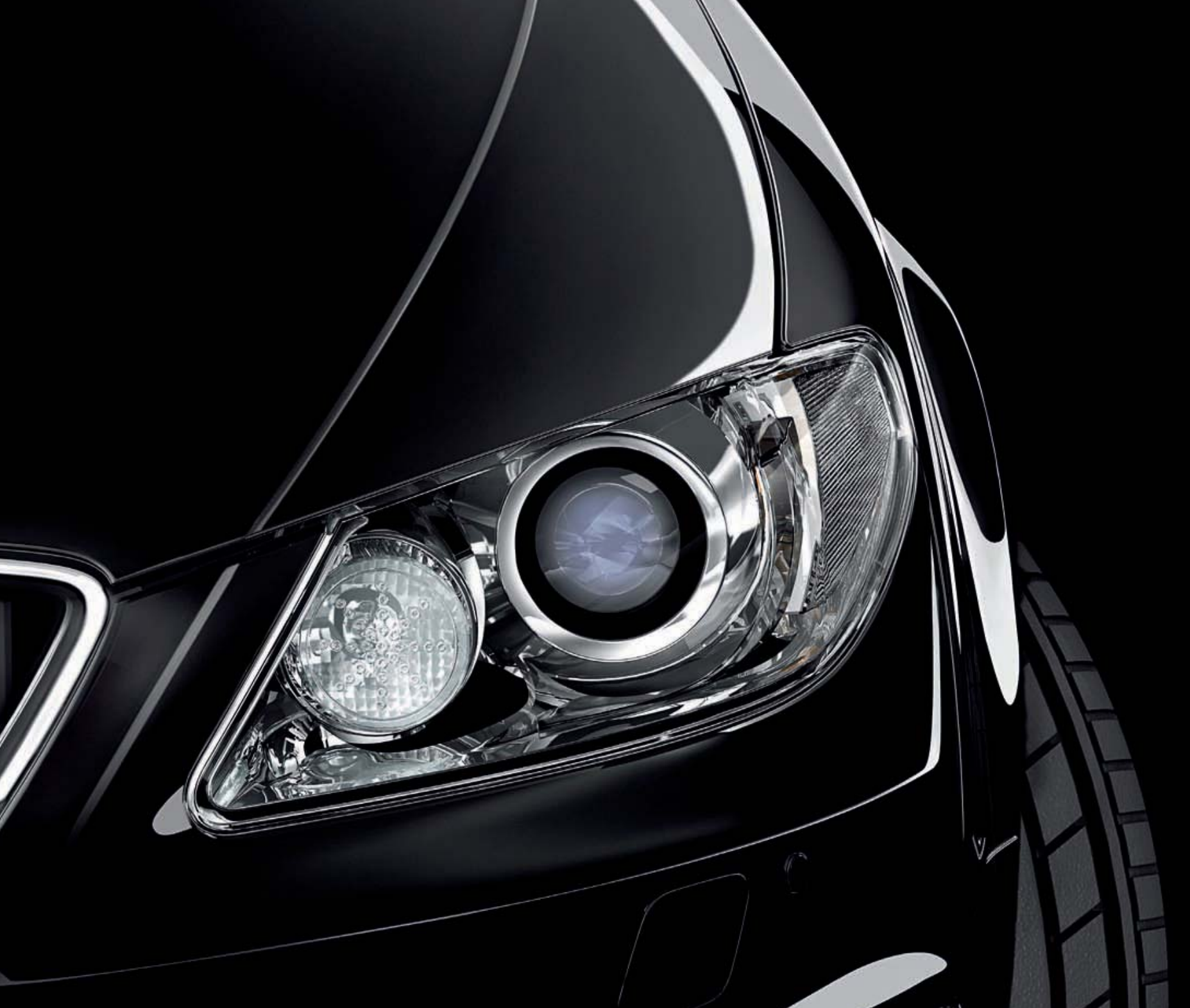
Le système AFS oriente les projecteurs en fonction des besoins du conducteur.
