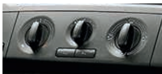
Climatisation à régulation mécanique.
