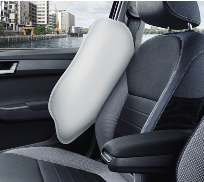
AIRBAGS LATÉRAUX En cas de collision latérale, ces deux airbags protègent le bassin et la poitrine des occupants.
